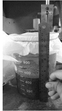
Gambar 6. Pengukuran tinggi endapan lumpur dan limbah pasir foundry
