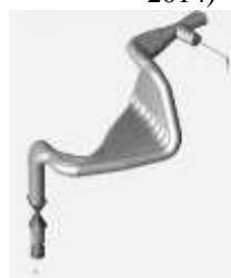
Gambar 5(a). Mode shape pada 13,443 Hz (Modal analisis di CAESAR II 2014)
