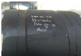
Gambar 1 Pipa SS400 dengan Coating Asphalt Enamel
