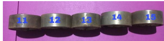
Gambar 7. Hasil Tampilan Permukaan Spesimen Setelah Dilakukan Pengujian Korosi
