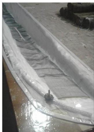
Gambar 2. Matt, WR, dan Peelply Disusun Diatas Cetakan
