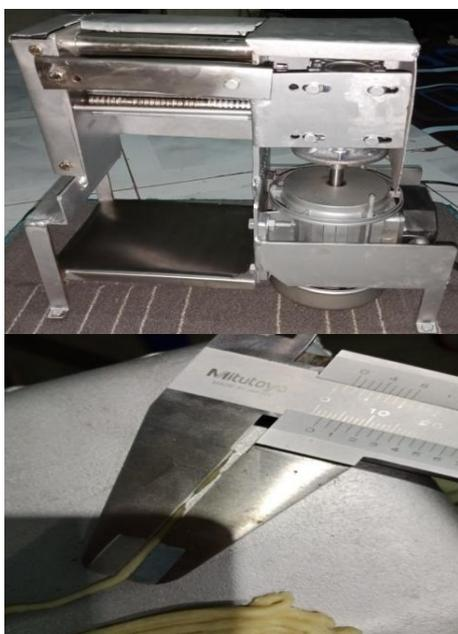
Gambar 1. Mesin Roll Press Cutting Otomatis Penggiling Adonan Mie dan Adonan Mie Yang Dihasilkan Mesin.
