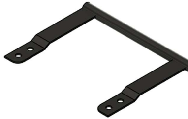
Gambar 10. Bracket di Bawah Begel Motor
