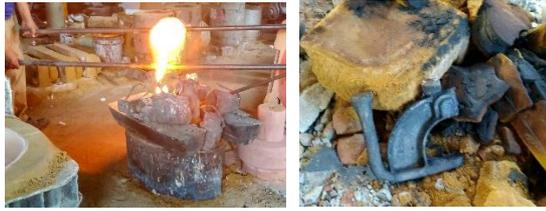
Gambar 3.4 Proses penuangan dan pembongkaran cetakan
