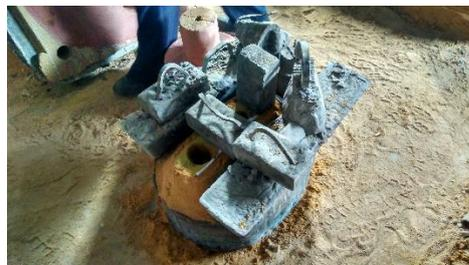
Gambar 3.3 Penambahan *backsand* pada Cetakan
