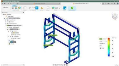
**Gambar 9.** Hasil Analisis Stress Konsep Desain 2 Rangka Rak
