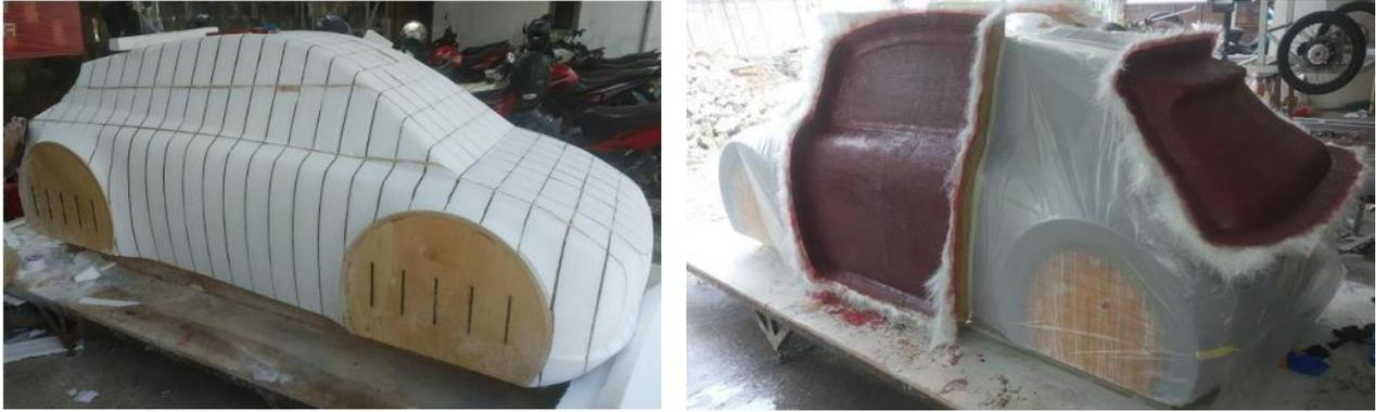
Gambar 3.2. Pemberian sterofoam pada mockup dan tahap pembuatan cetakan negative
