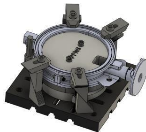
Gambar 5. Konsep Desain 2 Jig dan Fixture Full Assembly
