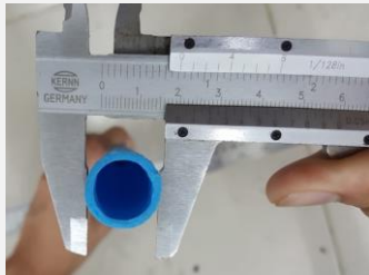
Dimensi hasil diameter luar menunjukkan 19.5 mm
