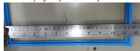
Dimensi yang dicapai 295.5 mm pada sumbu Y
