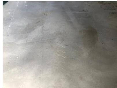
Gambar 3. 4 Plat yang belum di *Finishing Hairline*
