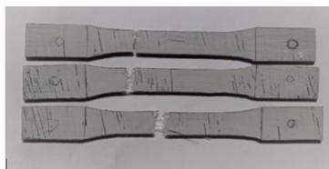
Gambar 5 Spesimen setelah uji ketahanan api
