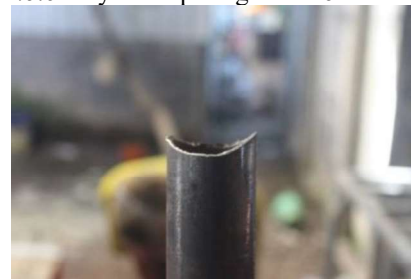
Gambar 5. Hasil pencoakan pipa
