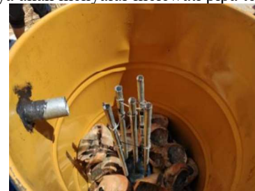
Gambar 3.11. Proses pembakaran pada tempurung kelapa
