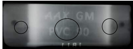
Gambar 10. Hasil Radiografi Bottom Part Tebal 11 mm
