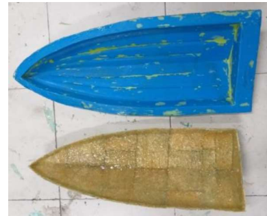
Gambar 3.4 Mold dan Hasil Cetakan Prototype Boat
