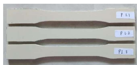
Gambar 10. Spesimen uji Tarik
