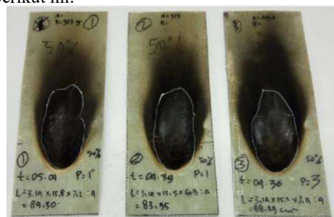
Gambar 7. Spesimen setelah uji ketahanan api
