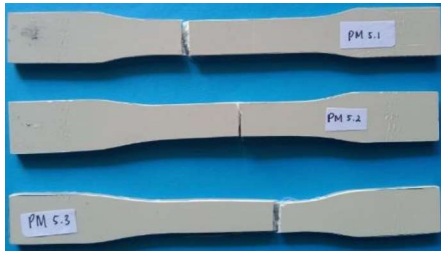
Gambar 11. Spesimen setelah uji Tarik
