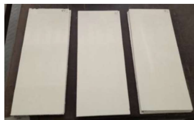
Gambar 6. Spesimen uji ketahanan api
