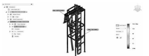
Gambar 6. Hasil Von Mises Stress Konsep Desain 1
