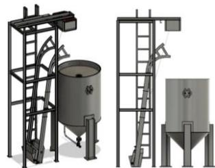
Gambar 3. Konsep Desain 2 tampak isometri dan tampak depan
