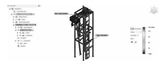
Gambar 8. Hasil Von Mises Stress Konsep Desain 2
