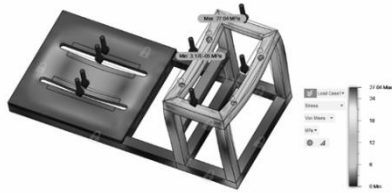
Gambar 9. Stress Analysis Rangka Konsep Desain 2
