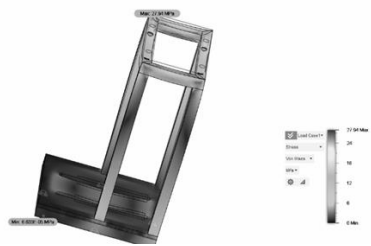
Gambar 10. Stress Analysis Rangka Konsep Desain 3
