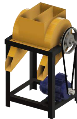
Gambar 3. 2 Konsep Redesign Mesin Perajang Empon-Empon 1
