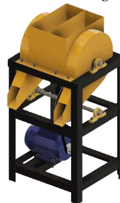
Gambar 3. 1 Desain Awal Mesin Perajang Empon-Empon
